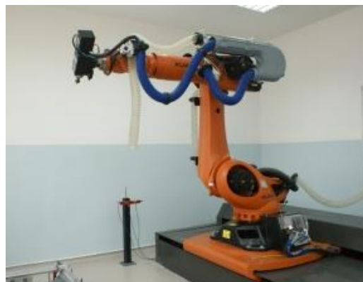
Робот для зачистки кромок авиационных деталей фирмы KUKA
