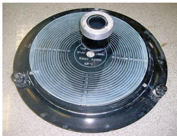
Рис. 1. Форма-конус: а – схема конуса; б – измерительный столик и конус
