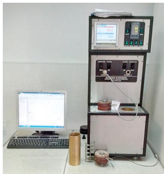
Рис. 2. Внешний вид консистометра: а – схема измерительного узла: 1 – лопастное устройство, 2 – стакан; б – внешний вид
