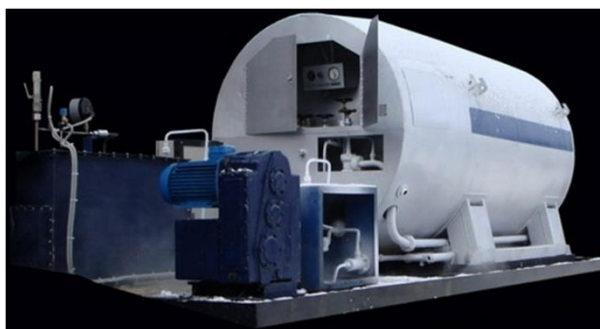
Рис. 1. Автомобильная газификационная установка АГУ-8К
