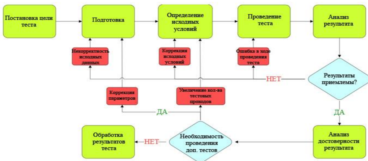
Рис. 3. Типовая схема проведения опытных работ при выборе технологических режимов
