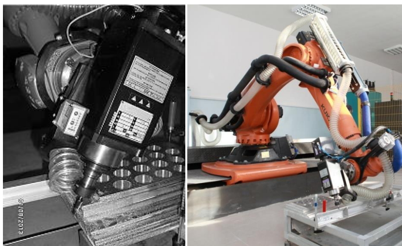
Рис. 3. Роботизированная механическая обработка кромок
