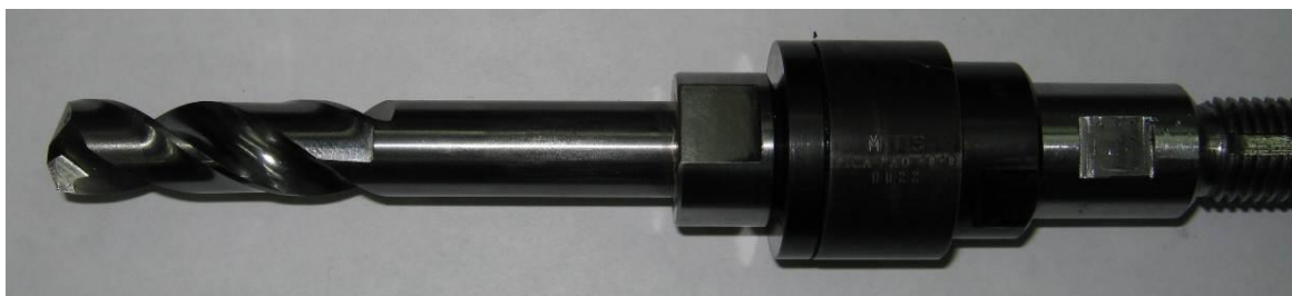
Рис. 4. Сверло, блок микровибраций MITIS, шпиндель (слева на право)
