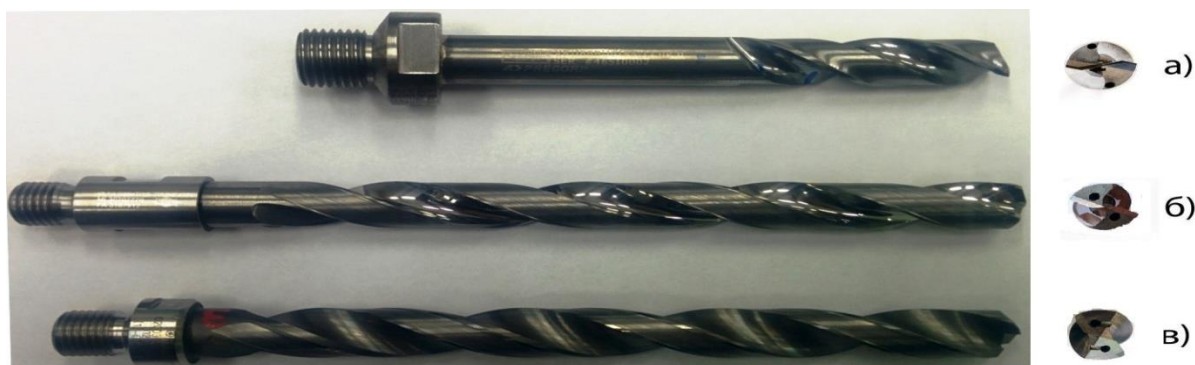
Рис. 1. Исследуемый инструмент: а – сверло Sandvik Coromant 86PT, б – сверло MAPALMI 30707779, в – Recoules 02003939PT
