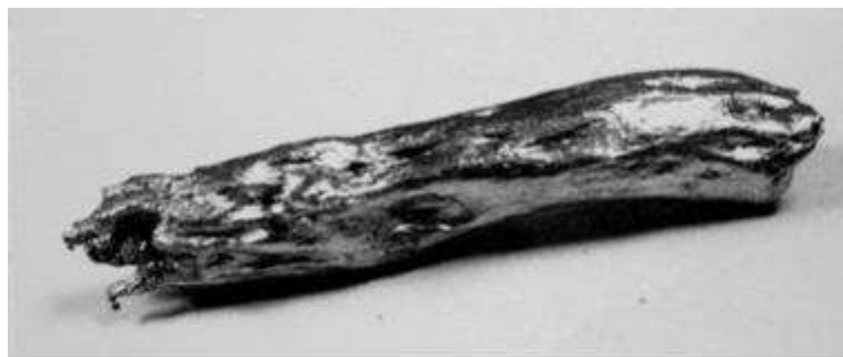
Рис. 3. Вид самопроизвольно деформировавшегося цилиндрического образца железа после термоциклирования в водороде
