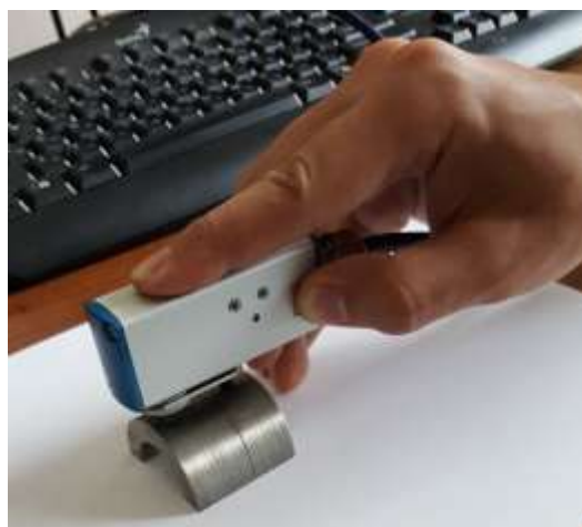
Рис. 4. Измерение шумов Баркгаузена в клапане: а – Rollscan 300; б – положение датчика при измерении
