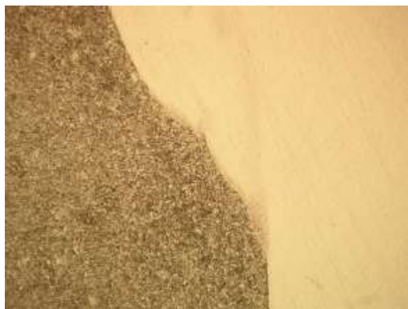
Рис. 3. Микроструктура зоны термического влияния, x50: феррит + перлит
