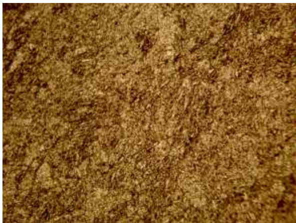
Рис. 2. Микроструктура наплавки после термообработки, x200: мартенсит
