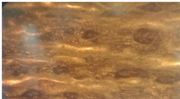
Рис. 1. Покрытие, полученное в электролите (I) при силе тока 1,2 А
